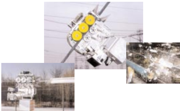
Déglaceur d'urgence pour câbles de garde et conducteurs.
