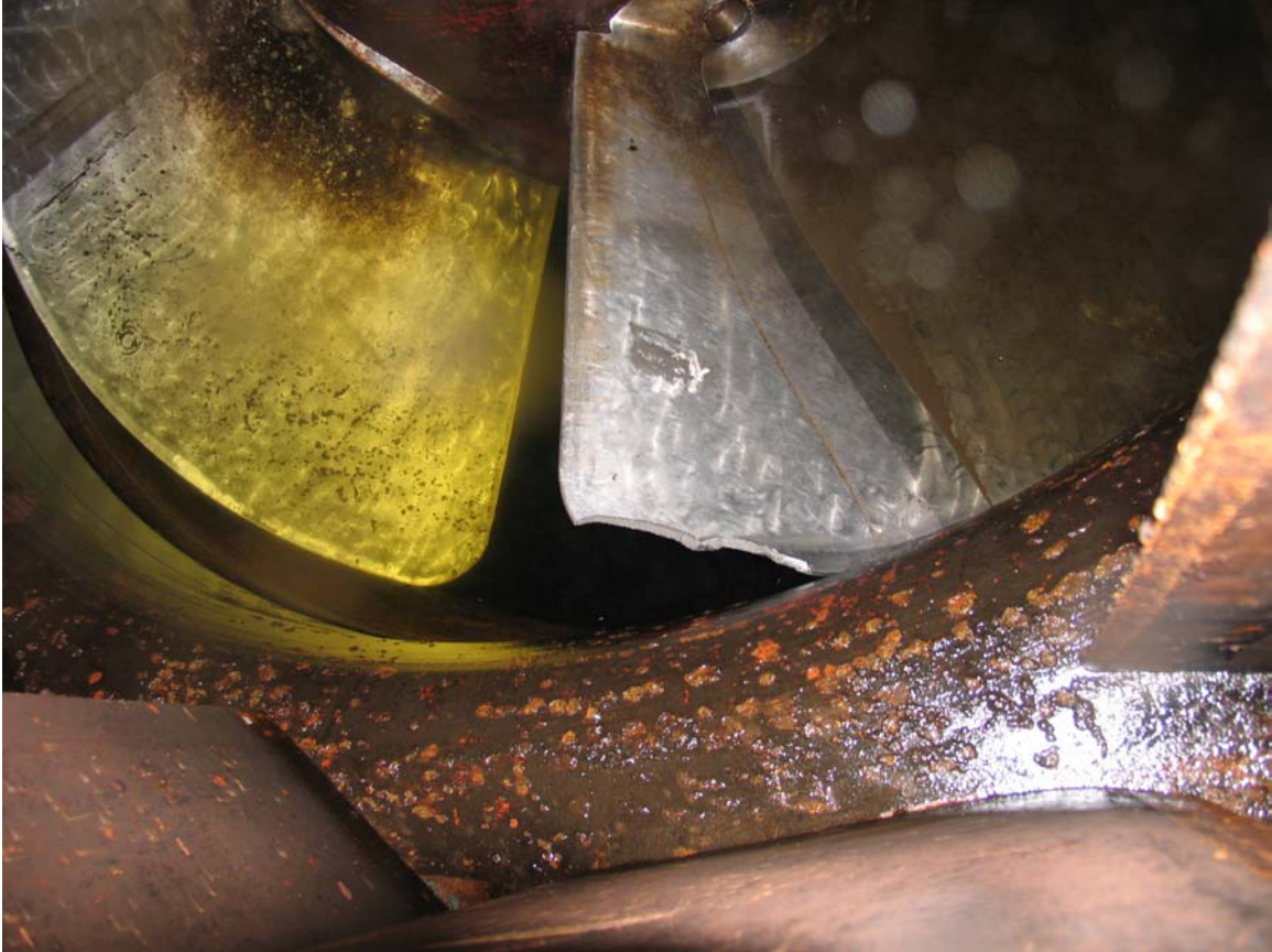
Figure 11: Pale cassée au bord d'attaque.
