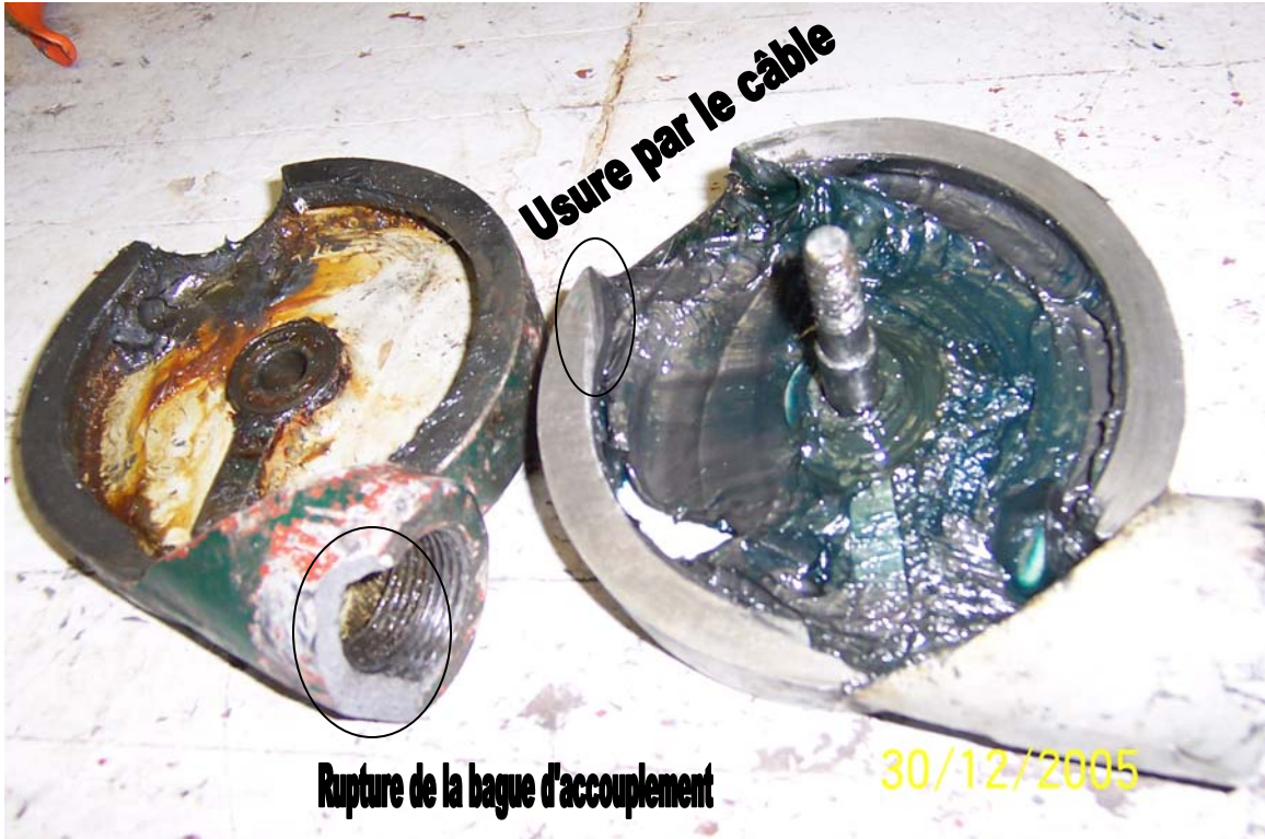
Figure 4: Boîtier de poulie endommagé
