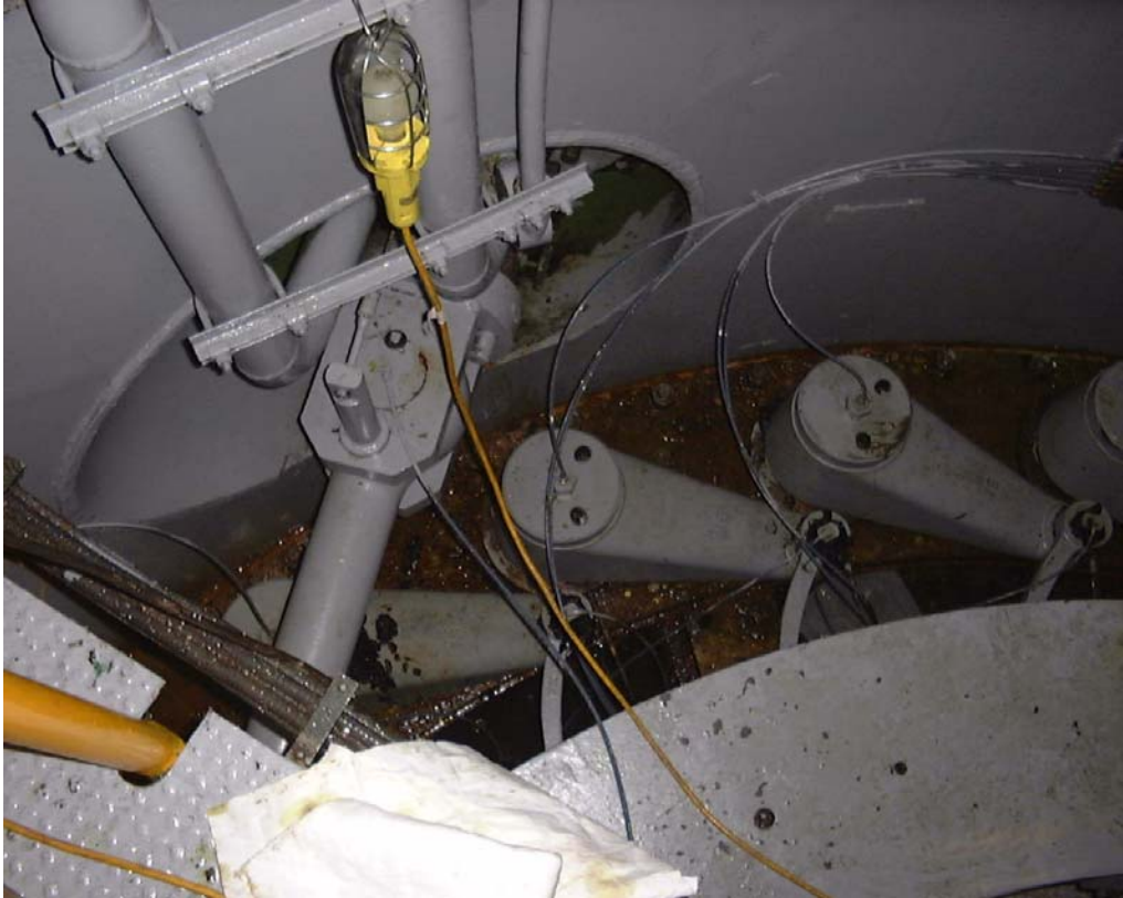
Figure 11: Leviers et biellettes en position fermée (avant le bris)
