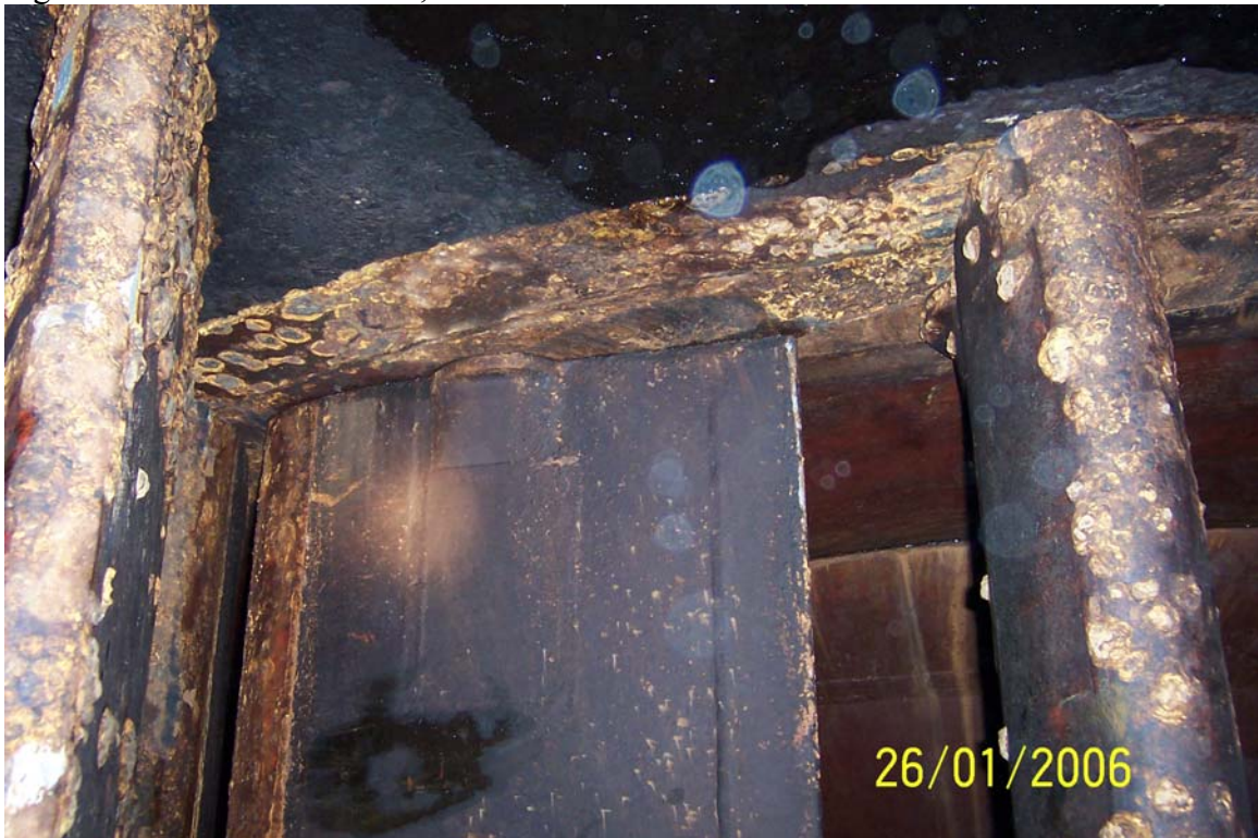
Figure 3: Directrice retournée, coincement sur le fond supérieur
