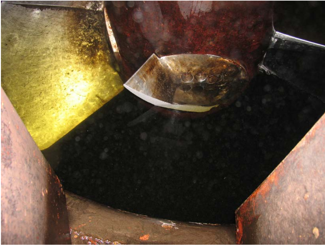
Figure 9: Pale de roue manquante
