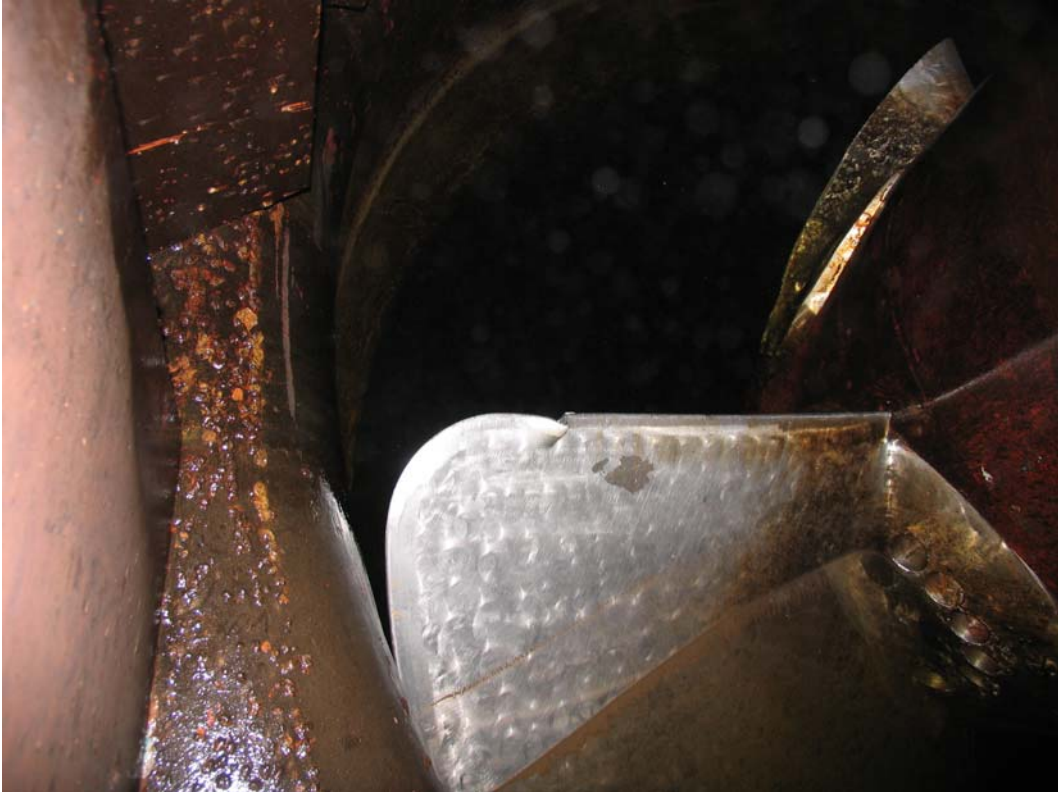
Figure 10: Pale déchirée au bord d'attaque
