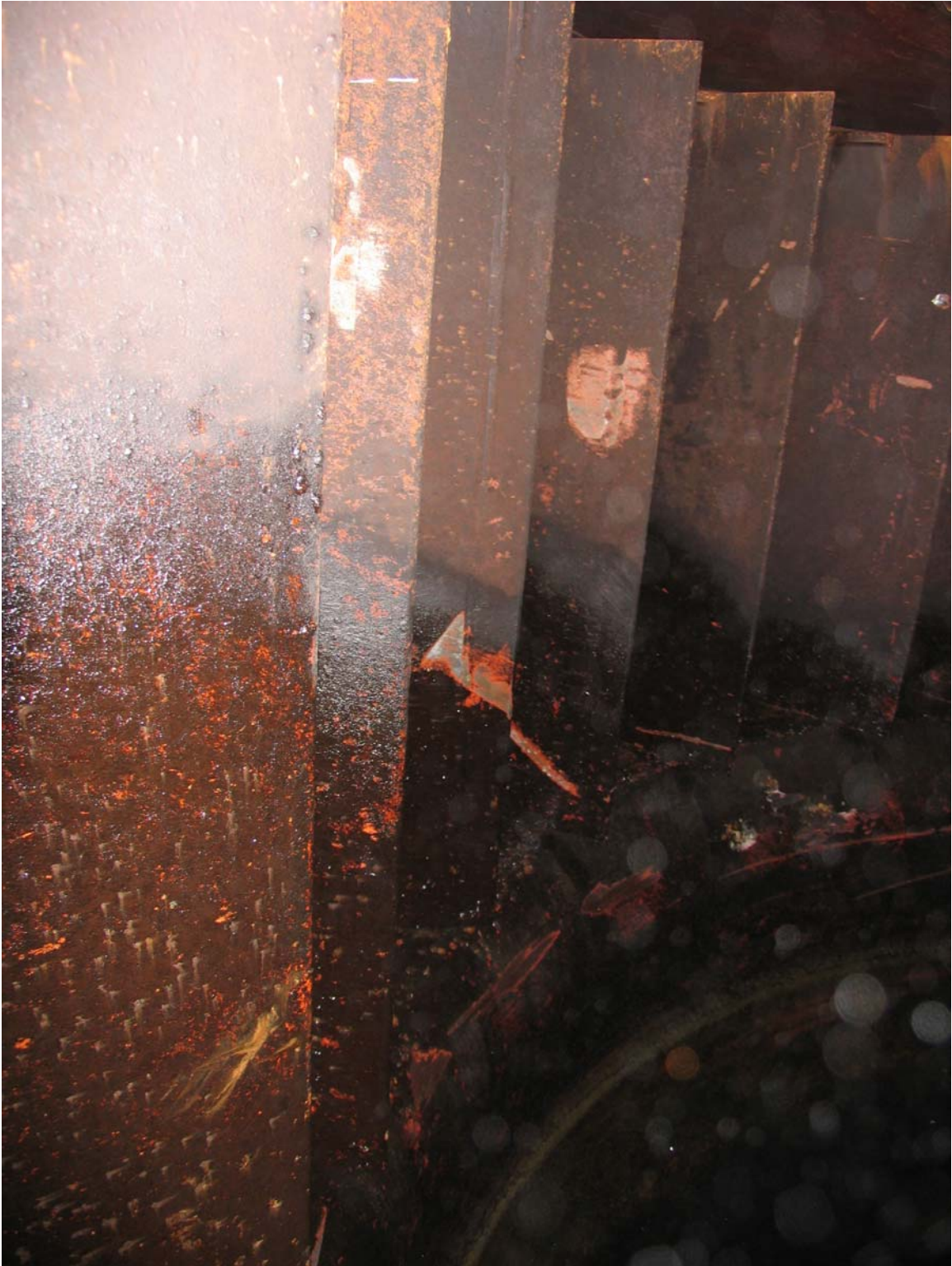
Figure 4: Trace d'impacts sur les directrices et le manteau de roue.
