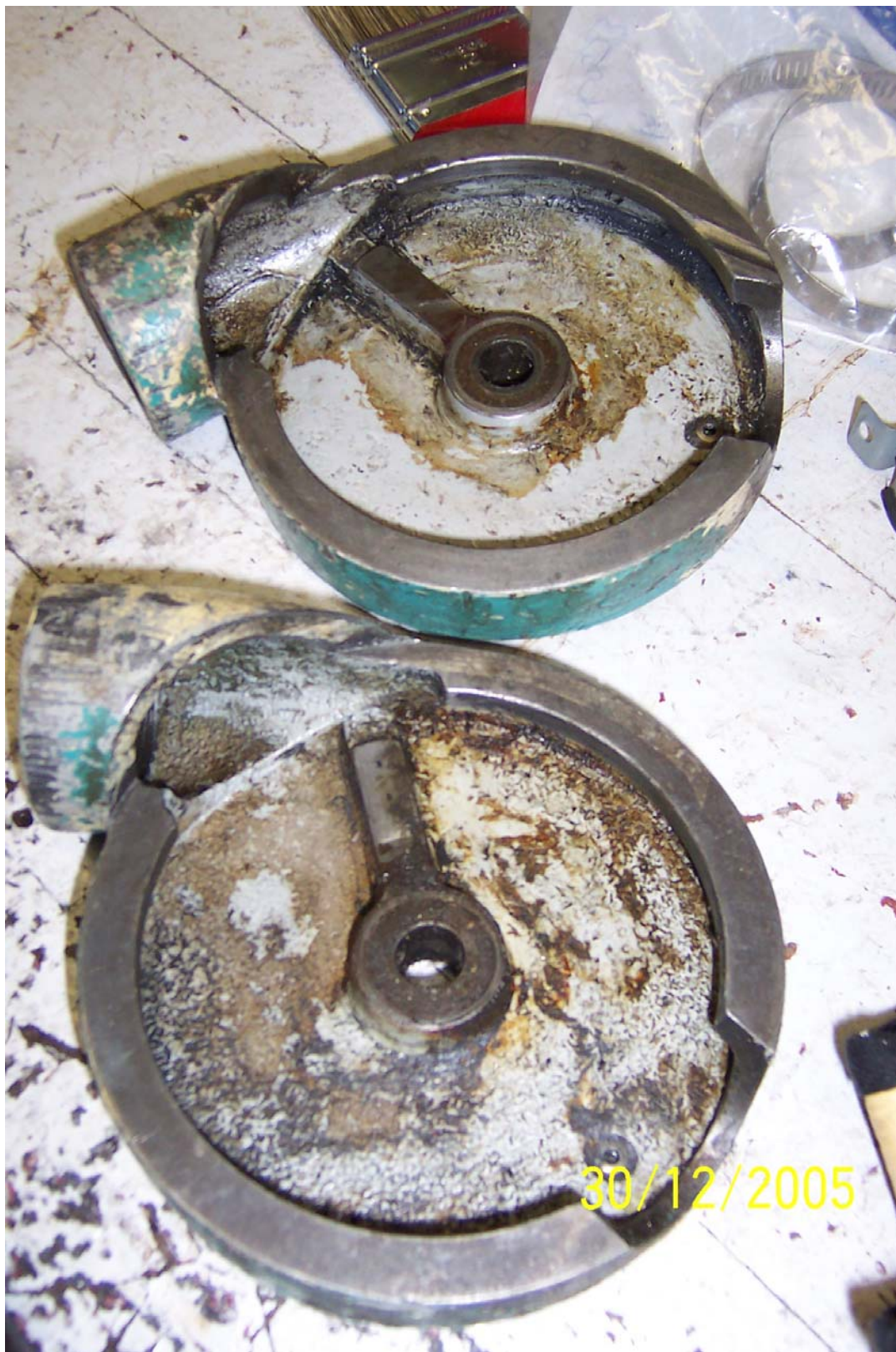
Figure 5: Dommage au boîtier de poulie, bris précédent du câble
