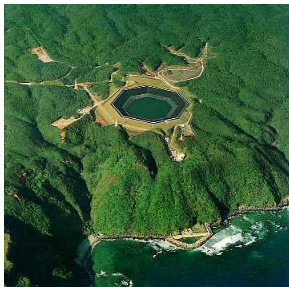
Centrale pilote de pompage hydraulique d'eau de mer d'Okinawa
