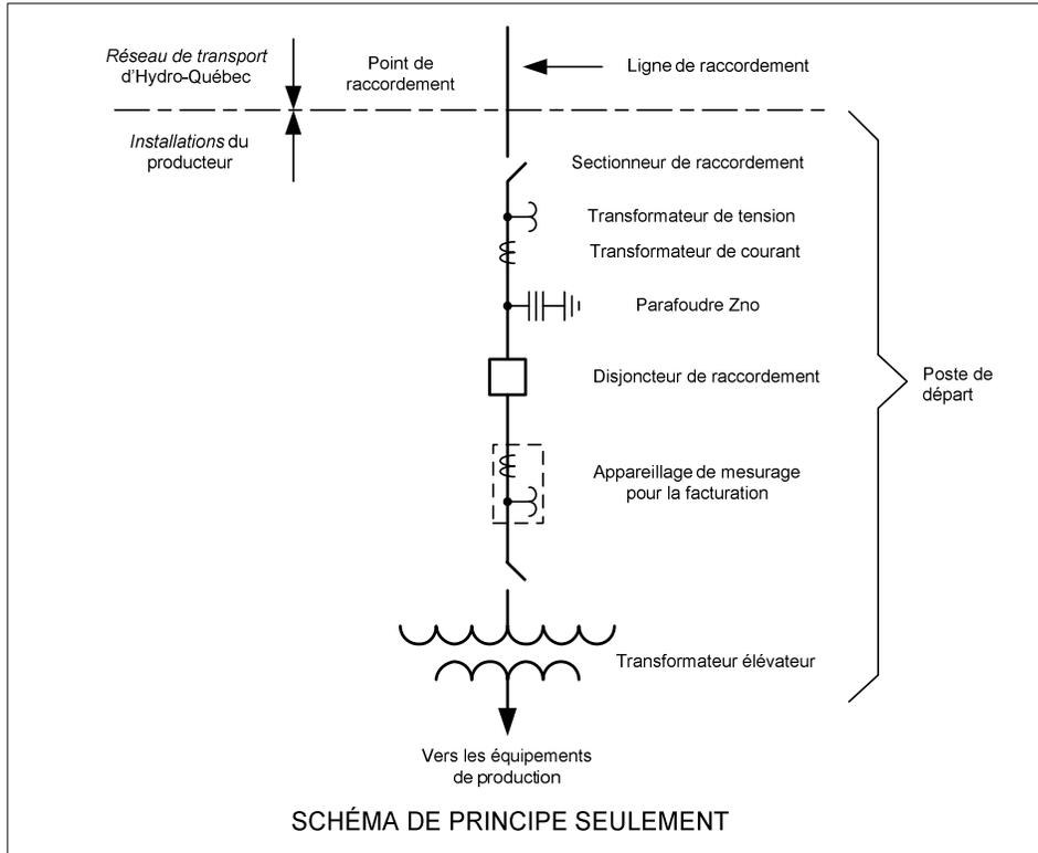
Le **point de raccordement** est le point de démarcation entre les équipements appartenant au *Transporteur* et ceux appartenant au producteur. Dans cette situation, le point de raccordement se situe généralement du côté haute tension du poste de départ.
