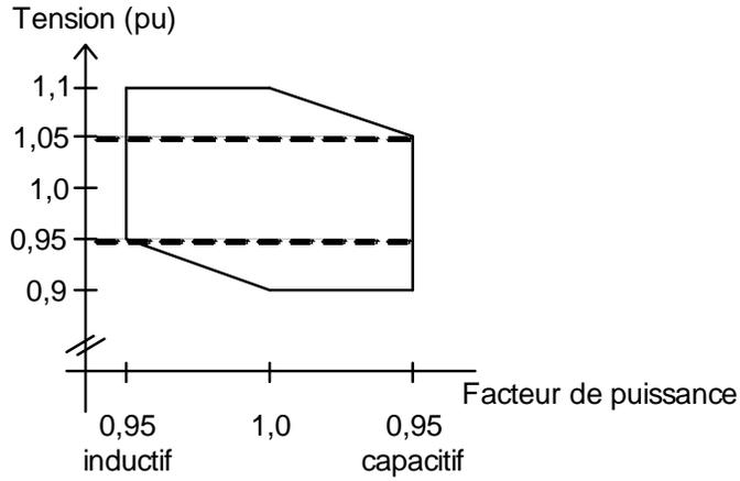
Tout en respectant le concept illustré par la figure 7, la puissance réactive disponible du côté haute tension du poste de départ en fonction de la puissance active variable des éoliennes en service, doit au moins s'élever à 0,33 p.u. (équivalent à un facteur de puissance de 0,95) de la puissance assignée des éoliennes en service, tel qu'illustré à la figure 8.
