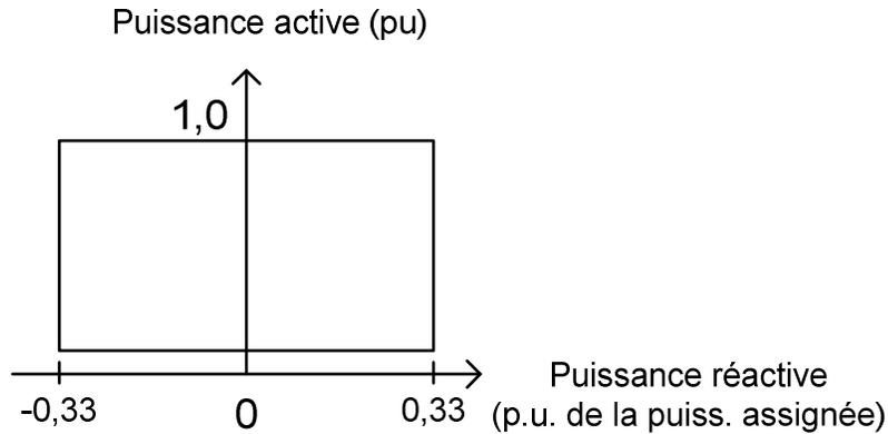
Si l'étude d'intégration montre que la puissance réactive de la centrale éolienne ne peut être complètement utilisée sur le réseau de transport, le Transporteur peut accepter un facteur de puissance supérieur à 0,95 sans toutefois excéder 0,97.
