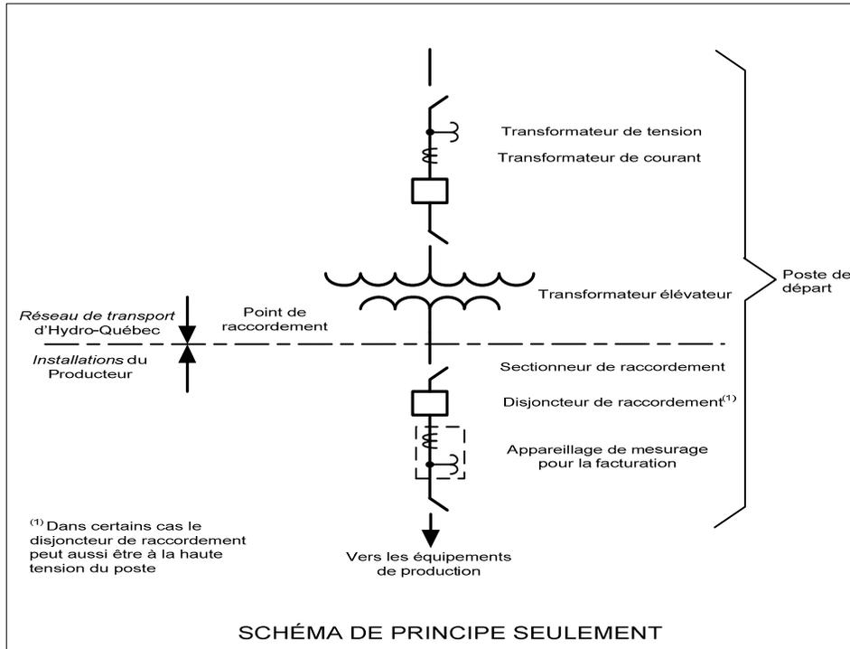
Le **point de raccordement** est le point de démarcation entre les équipements appartenant au *Transporteur* et ceux appartenant à Hydro-Québec Production. Dans cette situation, le point de raccordement se situe du côté basse tension du poste de départ.
