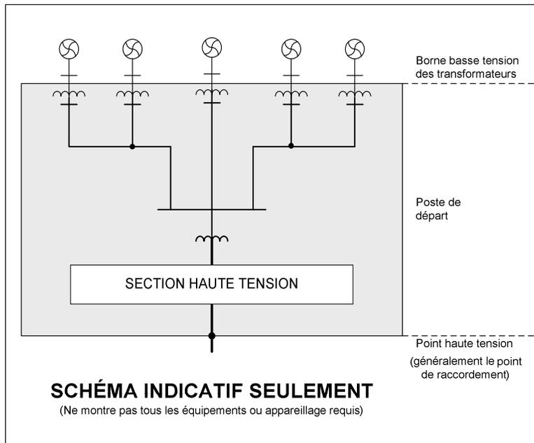
En addition à la description à la section 5.1 et pour l'application des exigences techniques strictement, le poste de départ comprend également, le cas échéant, les équipements de compensation ajoutés à la *centrale* éolienne par le producteur et servant au respect des exigences décrites dans les sections qui suivent.
