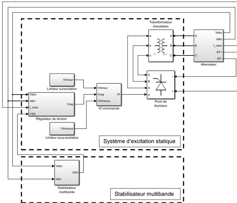
Les ponts convertisseurs triphasés à thyristors doivent être alimentés par un transformateur d'excitation raccordé aux bornes de l'alternateur. Le système d'excitation doit comprendre tous les dispositifs nécessaires à l'alimentation du champ d'un alternateur et doit pouvoir contrôler adéquatement la tension aux bornes de l'alternateur dans toutes les conditions d'exploitation.
