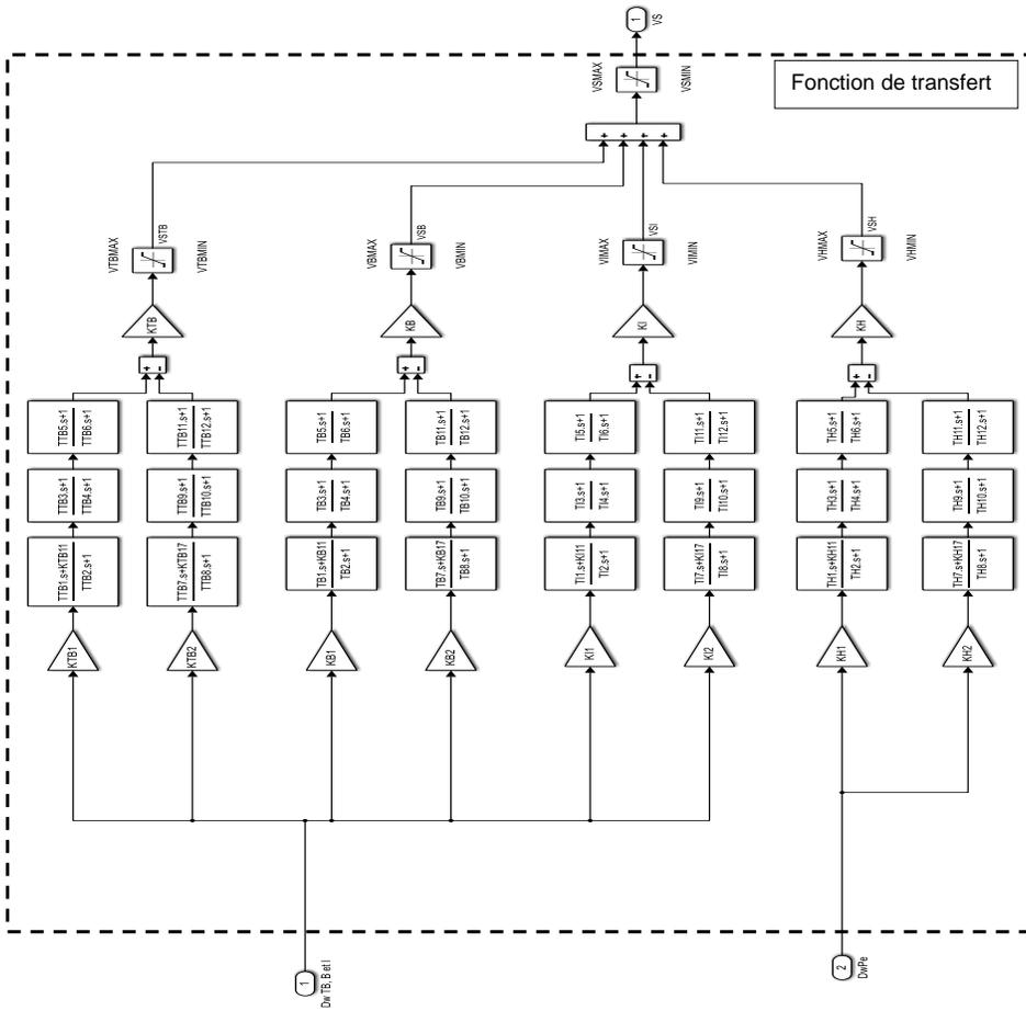
Cette fonction doit être conçue pour agir séparément sur quatre bandes de fréquence. Chacune des bandes doit disposer d'un gain global et d'un limiteur. La fonction de transfert doit comprendre également un limiteur à la sortie du stabilisateur. Chacune des bandes doit être constituée de deux segments montés en filtre différentiel qui doivent comprendre chacun un gain, un bloc avance-retard ou passe-haut ainsi que deux blocs avance-retard en série.
