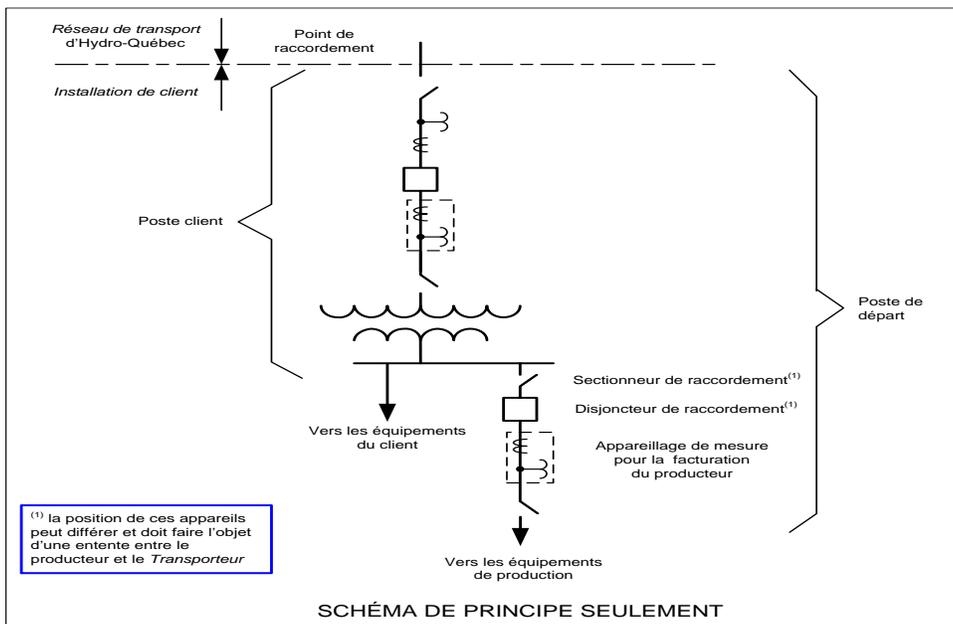
Le **poste client** doit être conforme aux « Exigences techniques de raccordement d’installations de client au réseau de transport d’Hydro-Québec » [1], telles qu’elles sont approuvées de temps à autre par la Régie de l’énergie.
