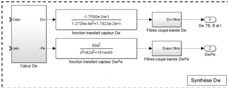
Deux filtres numériques de type coupe-bande (Dw et DwPe) montés en cascade doivent être disponibles au besoin pour les applications avec des turbines-alternateurs afin d'atténuer suffisamment les effets des modes torsionnels sur la mesure de vitesse. Pour ces applications, les filtres coupe-bande  $N_i(s)$ , doivent être réglables en fonction de la fréquence de résonance  $\omega_i$  et de la caractéristique de largeur de bande  $B_i$  à -3 dB selon l'équation de la figure 3 :
