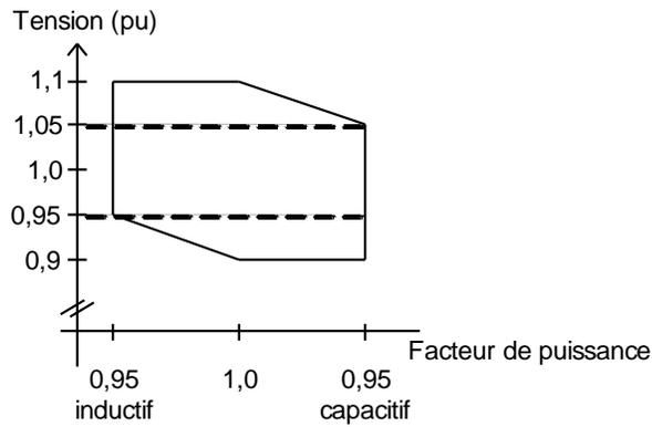
Tout en respectant le concept illustré par la figure 7, la puissance réactive disponible du côté haute tension du poste de départ en fonction de la puissance active variable des éoliennes en service, doit au moins s'élever à 0,33 p.u. (équivalent à un facteur de puissance de 0,95) de la puissance assignée des éoliennes en service, tel qu'illustré à la figure 8.
