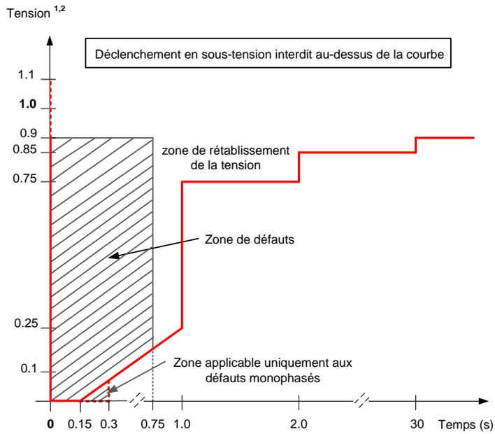
1. La tension de composante directe du côté haute tension du poste de départ
