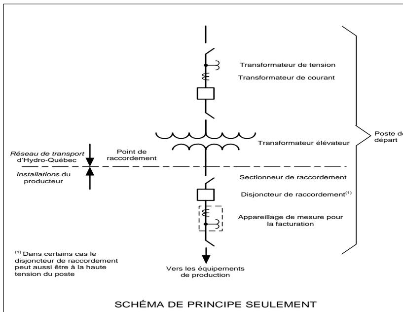
Le **point de raccordement** est le point de démarcation entre le *réseau de transport* et les *installations* du producteur. Dans cette situation, le point de raccordement se situe du côté basse tension du poste de départ.
