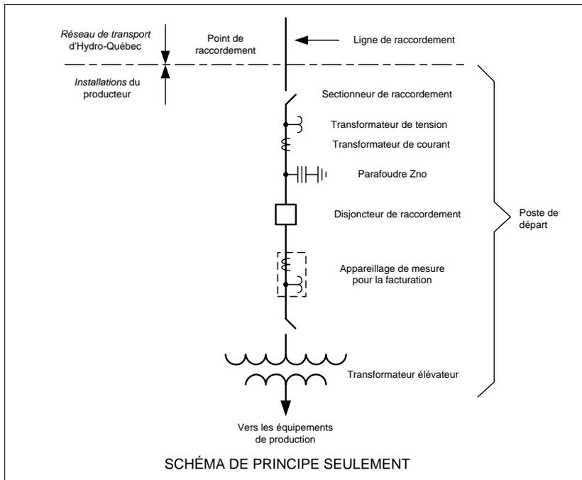
Le **point de raccordement** est le point de démarcation entre le *réseau de transport* et les *installations* du producteur. Dans cette situation, le point de raccordement se situe généralement du côté haute tension du poste de départ.
