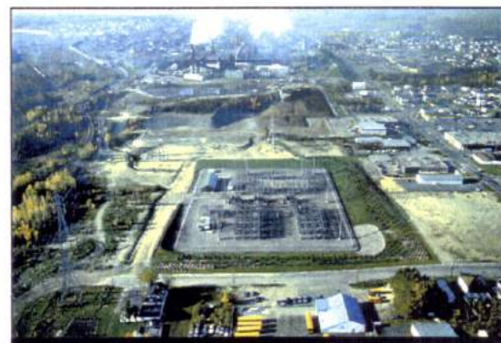
Figure 26 – le poste Thibodeau à 120-25 kV d'Hydro-Québec, à Shawinigan, a également été prévu à proximité de secteurs à caractère industriel ;
