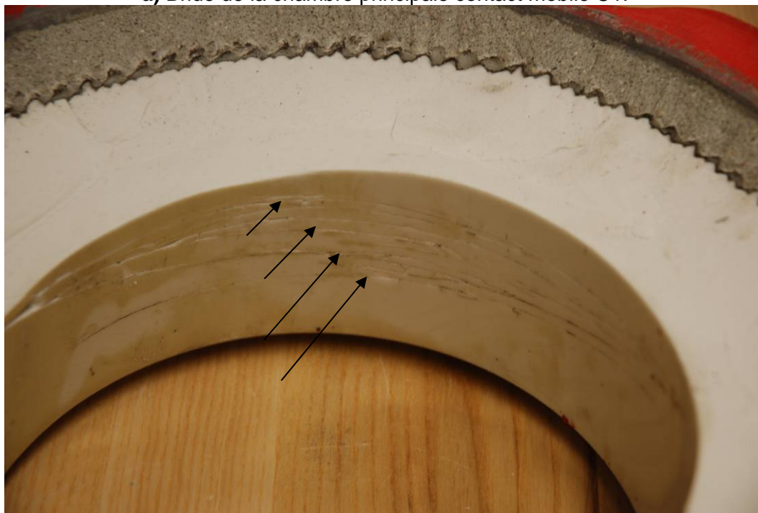
b) Fissuration multiple au niveau du site d'amorce principal.
