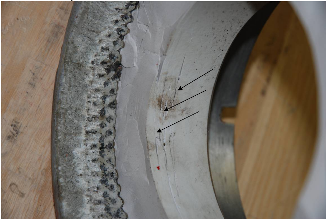
b) Fissuration multiple dans la région du site d'amorce du bris de la chambre auxiliaire.
