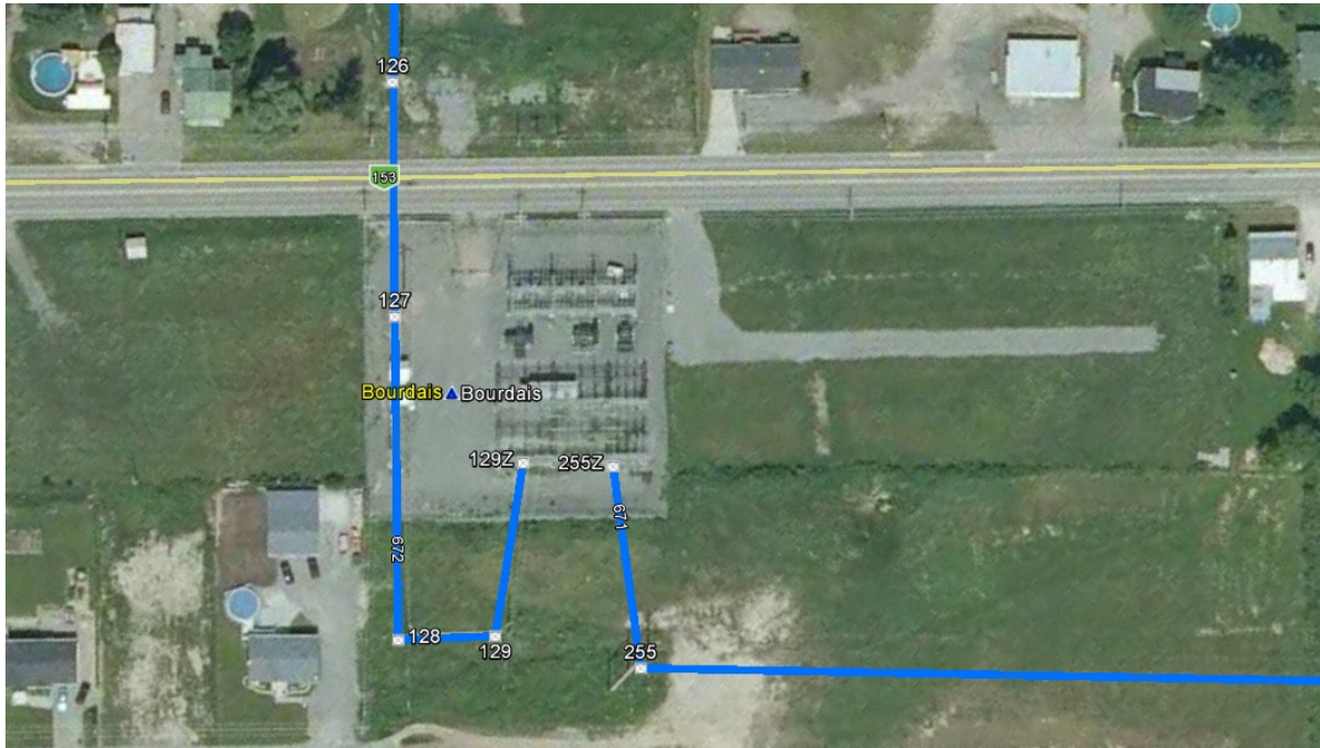
Figure 1 Vue aérienne du poste Bourdais à 69-25 kV
