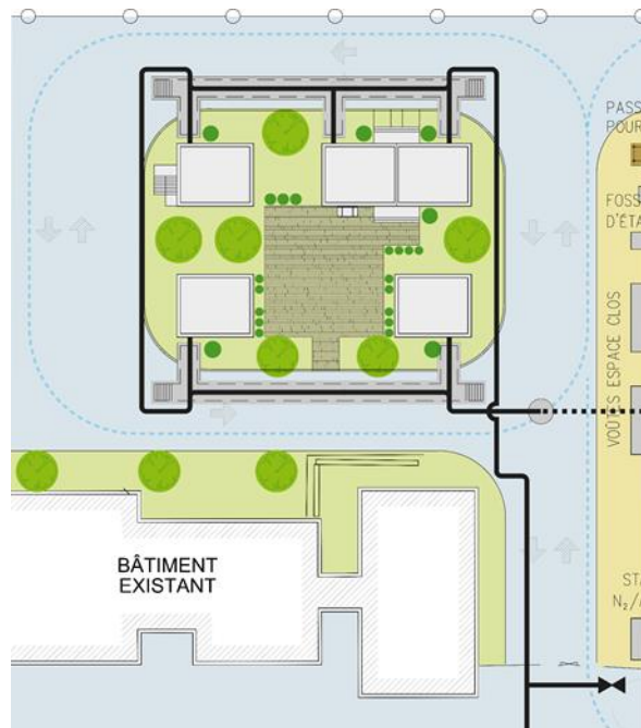
Schéma des canalisations de gaz du site qui seront équipées d'un fil traceur.
