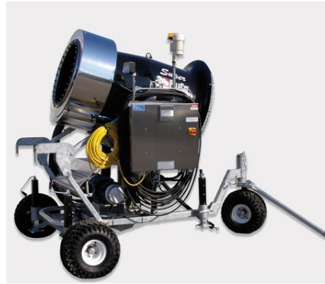
SMI Polecat automatic fan snowgun ( www.Snowmakers.com )
