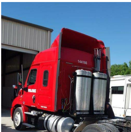
Figure 7 Réservoirs au propane
