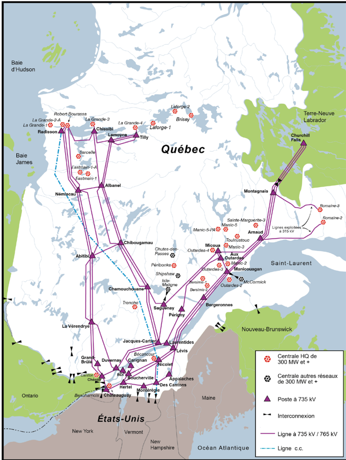
Figure 2 Réseau de transport du Transporteur
