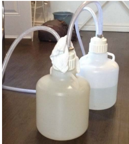
Figure 2-1 : Montage utilisé pour récupérer les sédiments lors de la vidange des chauffe-eau
