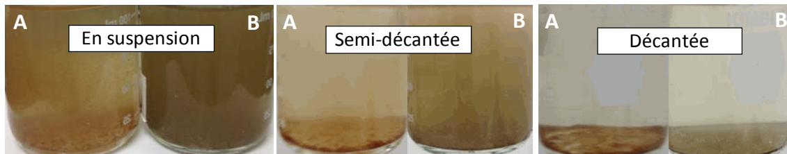
Figure 3-1 : Apparence des boues A et B après suspension, décantation partielle et après décantation complète
