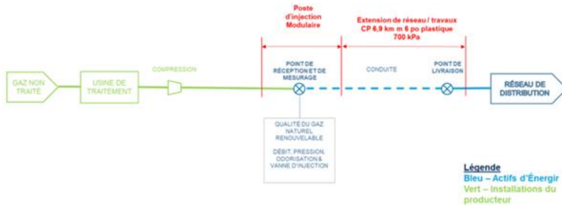
Figure 4 Schéma de la chaîne de valorisation du GNR produit par CBTM et distribué par Énergir
