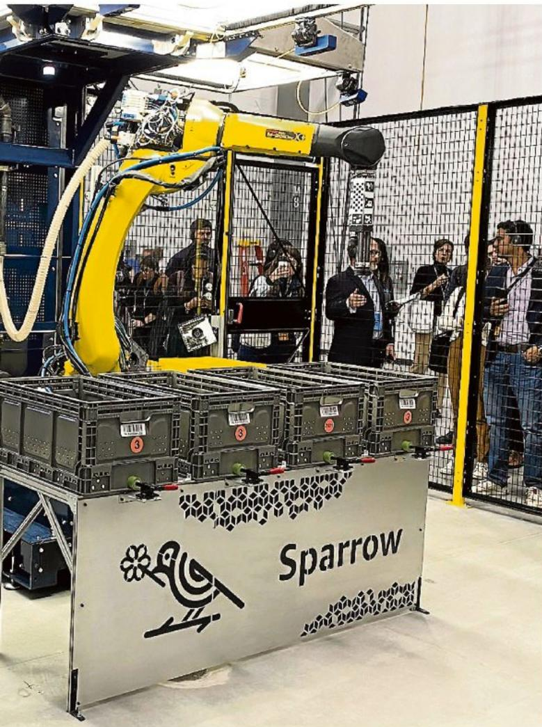
À Boston, Amazon nous a dévoilé Sparrow, le plus récent ajout à la famille des bras robotisés. Il utilise l'intelligence artificielle pour saisir des millions d'articles de différentes formes et de différentes tailles de façon répétitive. Le bras robotisé est capable de déceler quel est l'objet qu'il s'apprête à prendre, afin de trouver la façon idéale de s'adapter et de le manipuler. — PHOTO LE DROIT, PATRICK WOODBURY
