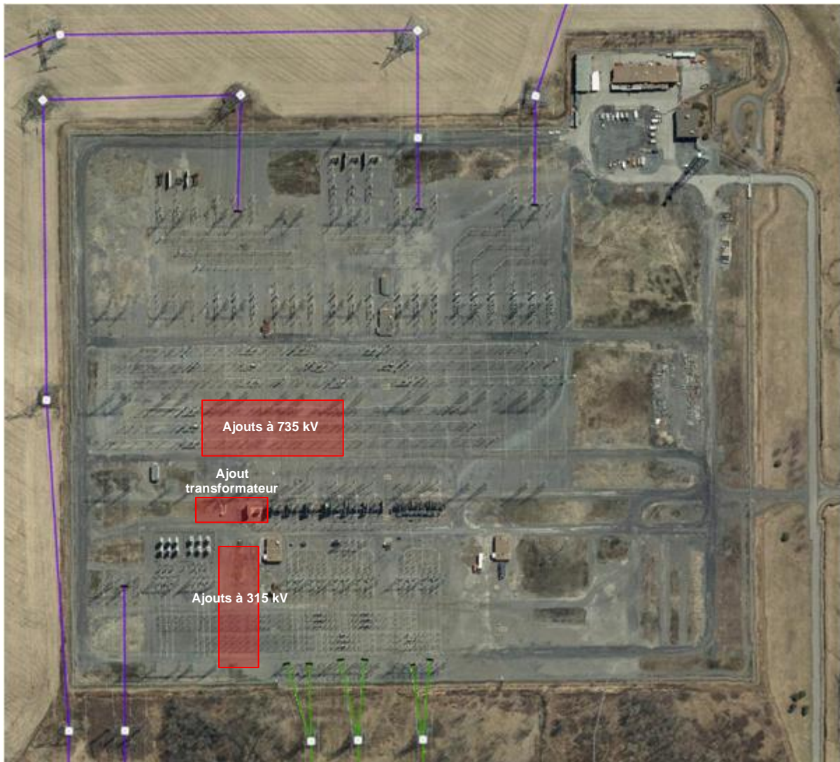
Figure 2 Emplacement du nouveau transformateur à 735-315 kV
