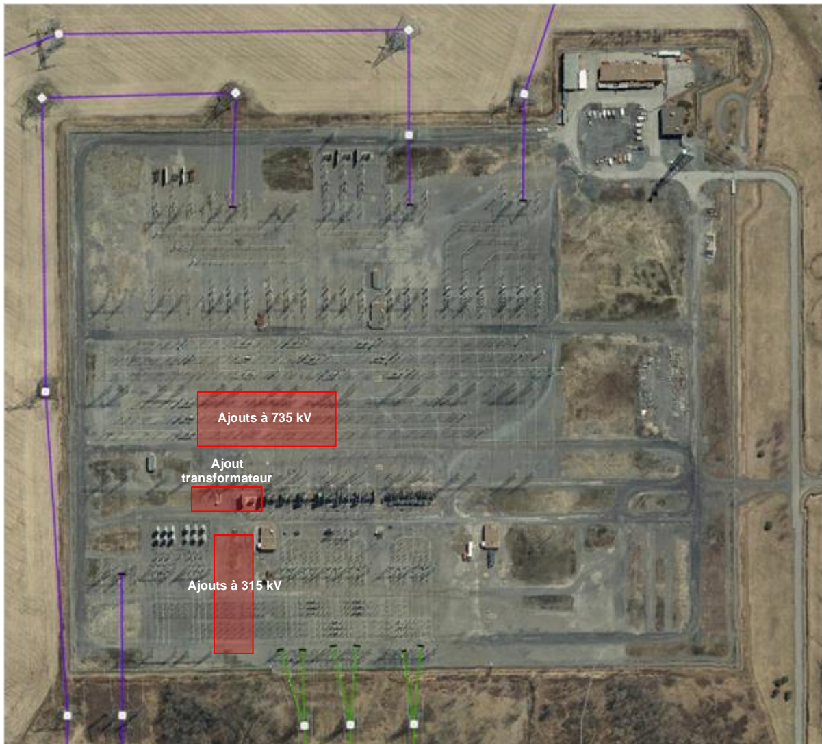
Figure 2 Emplacement du nouveau transformateur à 735-315 kV
