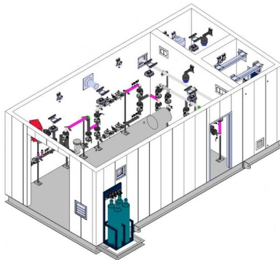
1 La solution retenue est la construction d'un poste d'injection de GNR qui occupera une superficie
