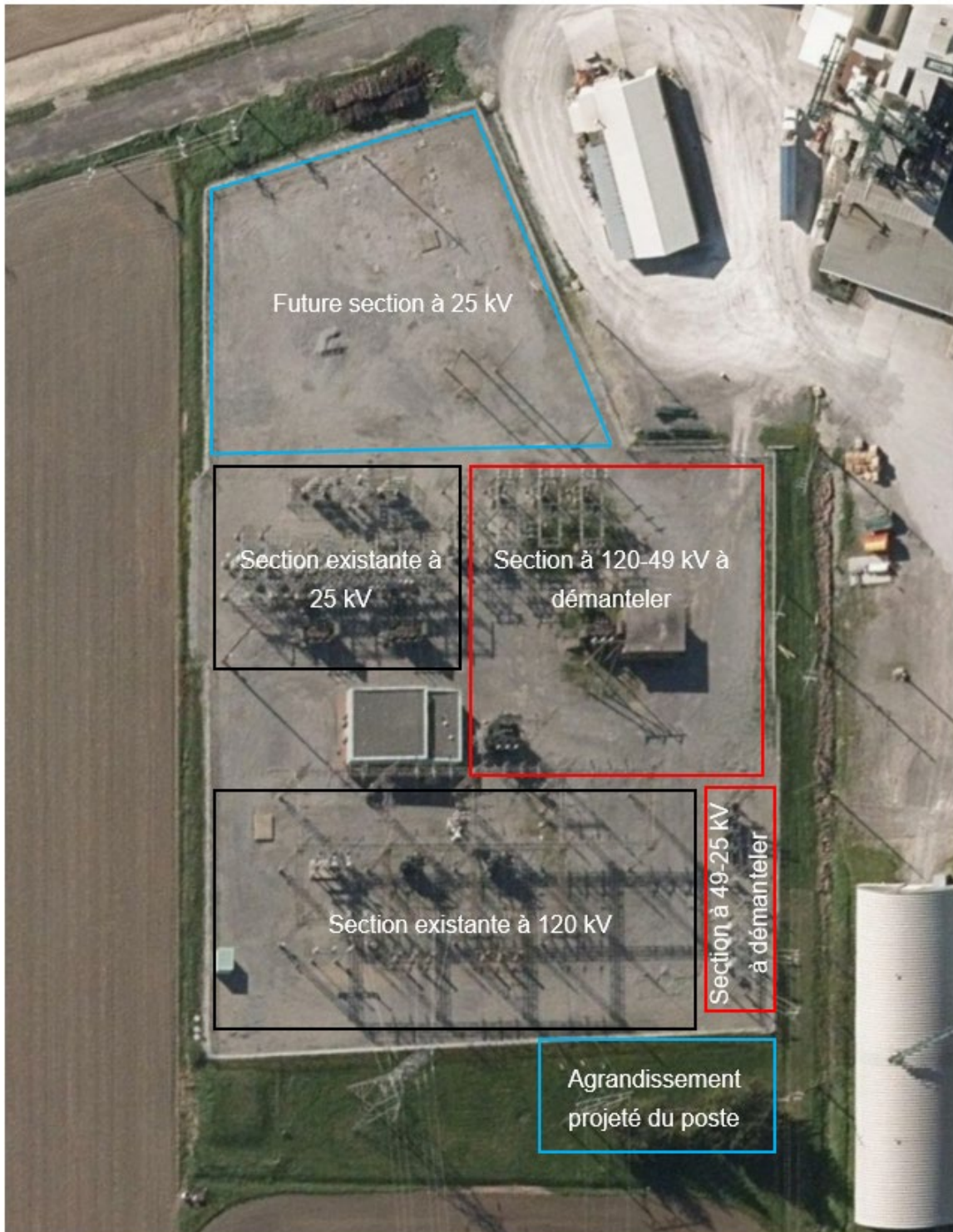
Figure 3 Réaménagement au poste de Sainte-Rosalie
