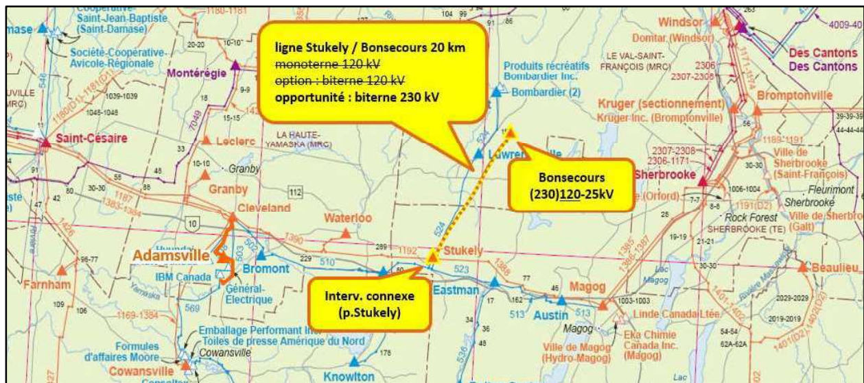
Figure 13 : raccordement au réseau du poste de Bonsecours
