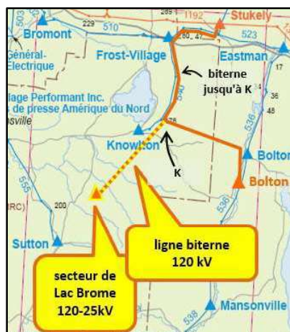
Figure 17 : raccordement au réseau d'un poste dans le secteur de Lac Brome par une ligne biterne provenant du poste de Stukely, avec dérivation souterraine vers le futur poste de Bolton
