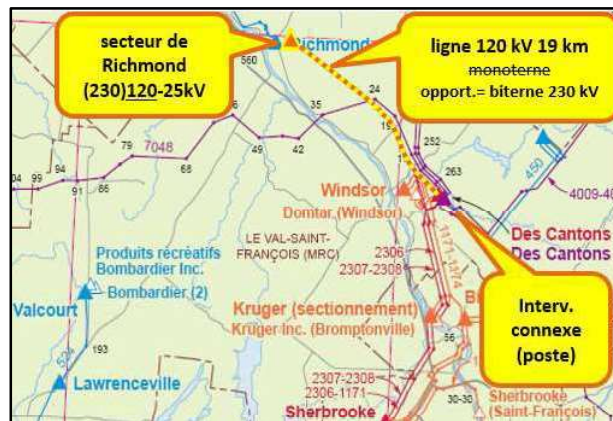
Figure 18 : raccordement au réseau d'un poste dans le secteur de Richmond
