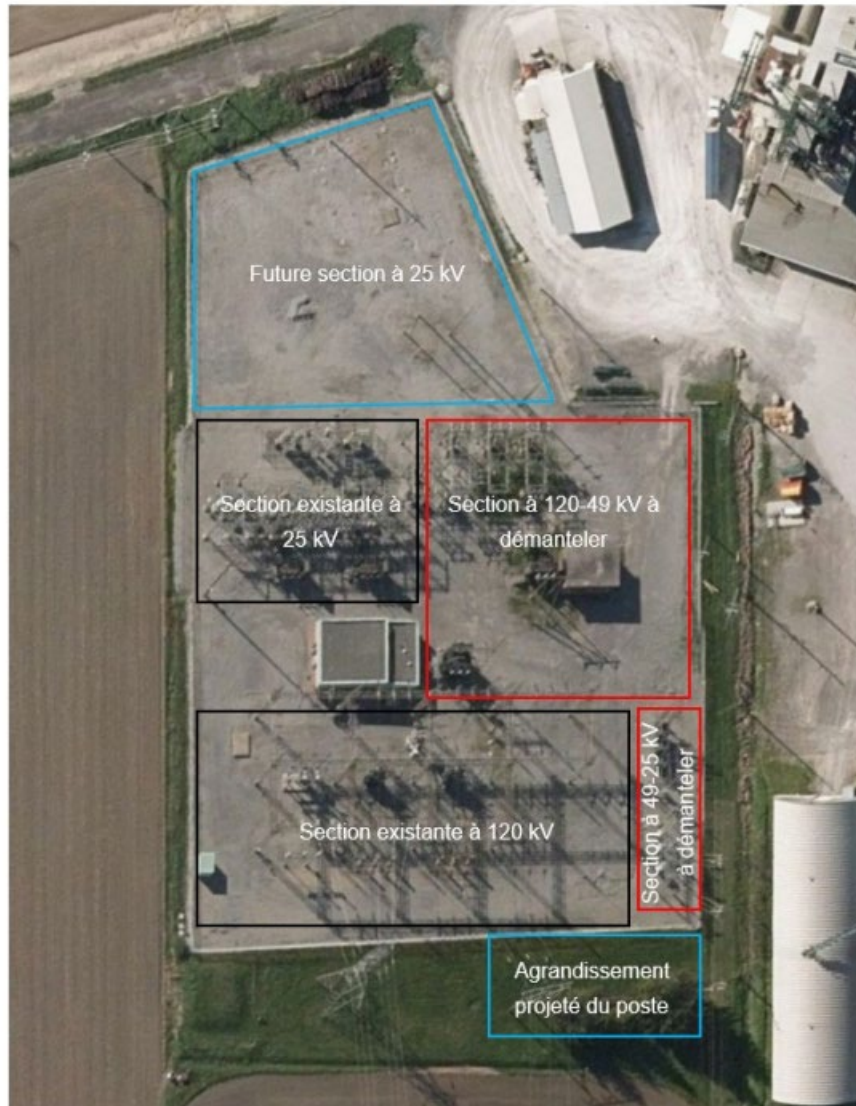
Figure 3 Réaménagement au poste de Sainte-Rosalie
